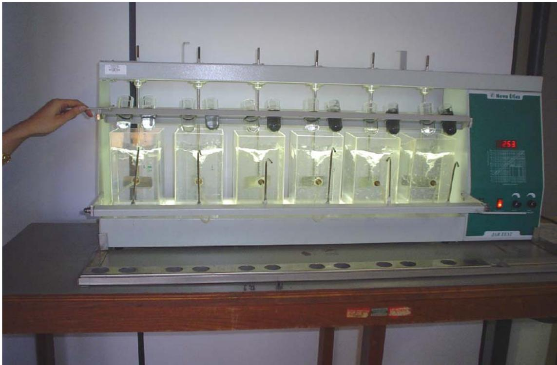
Figura 4.8 – Adição simultânea do CAP e do PAC nos experimentos
