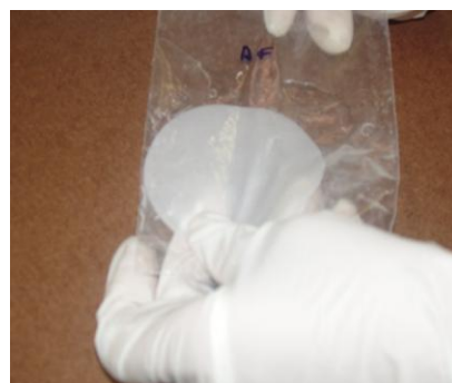
Figura 4.16 – Lavagem da membrana
